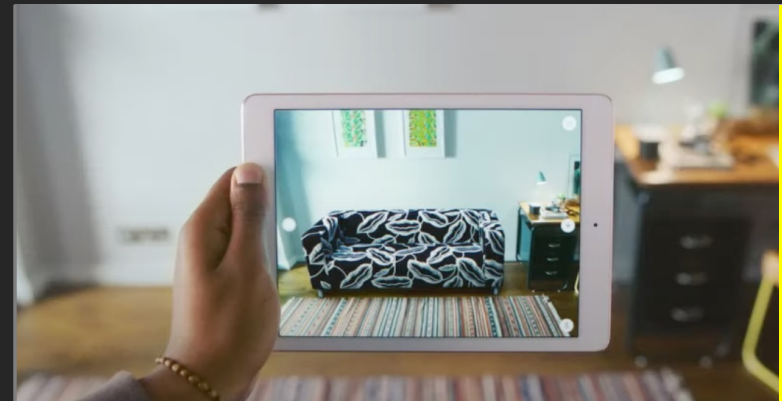
Figura: Câmera do tablet captura o ambiente o app insere o objeto.
